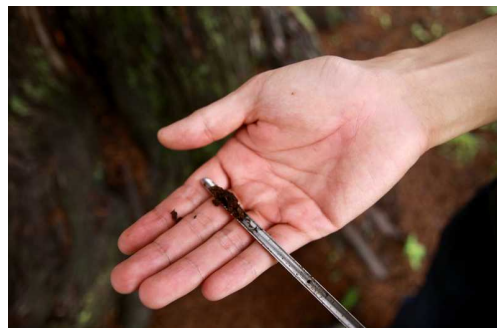
그림 3-37_인공수피 내부 부후상태 확인
