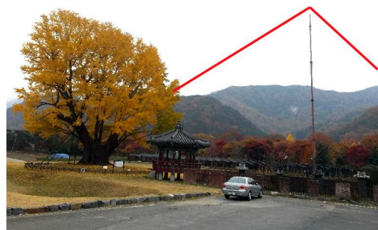
그림 3-82_금산 요광리 은행나무(84호)_노거수가 피뢰침의 보호범위 벗어남
